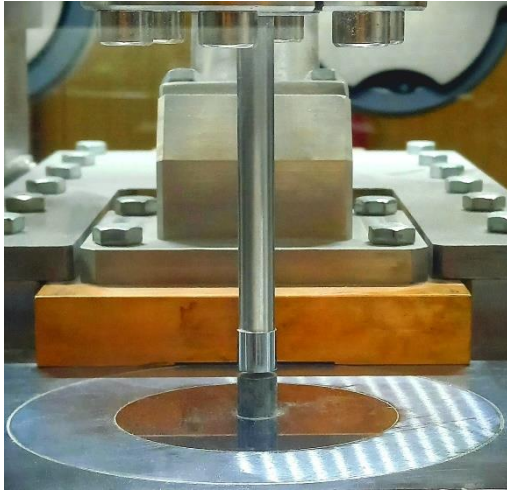
Photo d'une pastille d' UO_2 sous le poinçon d'une presse.
