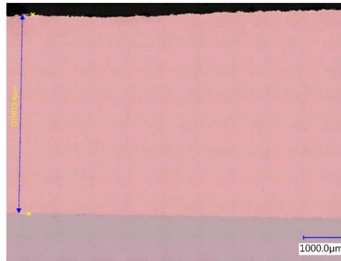
Dépôt de cuivre dense- épaisseur > 5 mm –rendement > 99%
