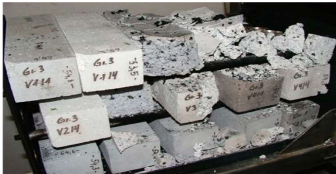
1. Test de résistance au CO de bétons réfractaires . (b) Type de carbone généré en fond de pore, qui endommage le réfractaire.
