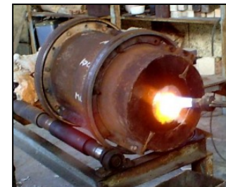
Test de four tournant à 1650–1700 °C (Moda et al., 2011)
